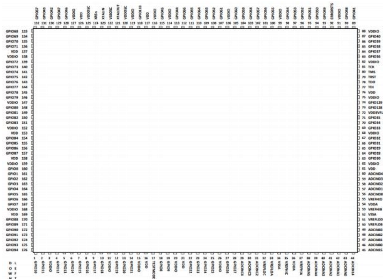
图 3.1 176Pin eQFP热增强型低剖面四通道扁平封装（顶视图）
