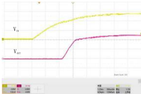
图 17. 软启动, V_{IN}=5.5V , V_{OUT}=5.0V , I_{OUT}=2A
