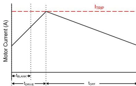
$t_{OFF}$  结束后，根据两个输入 INx 重新启用输出。在到达另一个  $I_{TRIP}$  之前的驱动时间( $t_{DRIVE}$ )在很大程度上取决于 VM 电压、电机的反电动势和电机的电感。
