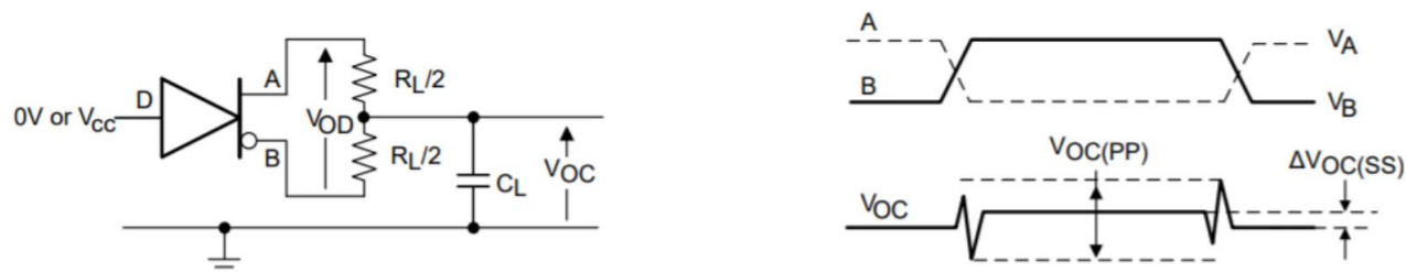
图 16. RS-485 负载下驱动器差分 and 共模输出的测量
