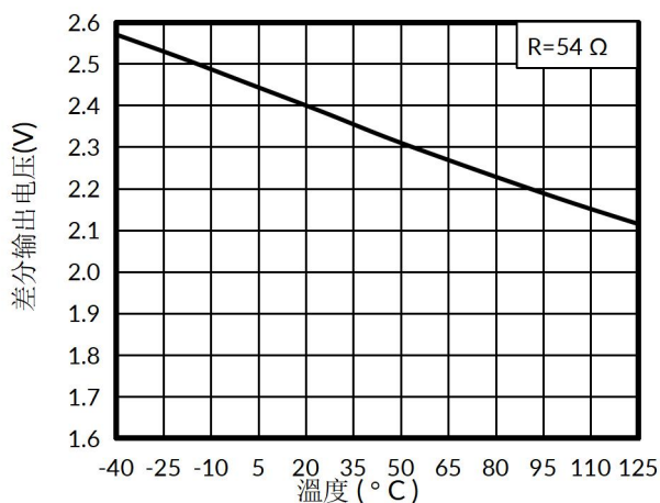
图 5. 驱动器差分输出 电压与温度
