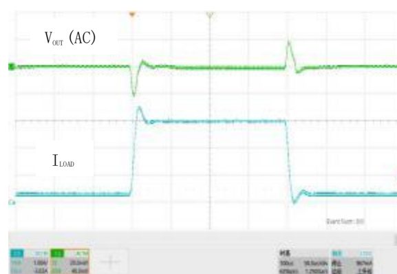
图 18. 负载瞬态响应, V_{IN}=2.8V , V_{OUT}=1.8V , I_{OUT}=0.1A to 1.5A
