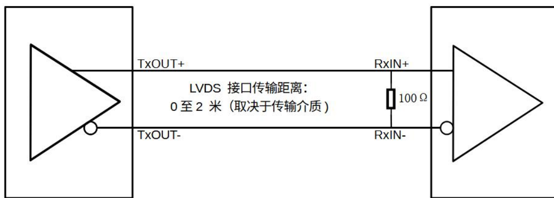
图 22. LVDS 串行链路终止
